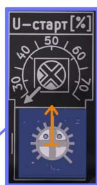
Потенциометром «У-старт» задаётся «Стартовое напряжение», с которого будет начинаться плавный пуск насоса, напряжение будет линейно расти начиная с этого уровня до действующего напряжения сети. [На иллюстрации приведен пример выставления Стартового напряжения в 50%.](#)
