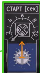
Потенциометром «СТАРТ» задаётся время, в течении которого будет линейный прирост напряжения на нагрузке с «Стартового напряжения» до 100% действующего напряжения сети. [На иллюстрации приведен пример выставления стартового времени 6 секунд.](#)
