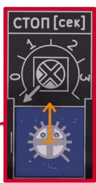
Потенциометром «СТОП» задаётся «Время остановки», в течении заданного промежутки времени будет производится линейное понижение напряжения на нагрузке. [На иллюстрации приведен пример выставления Времени остановки в 1,5 секунды.](#)
