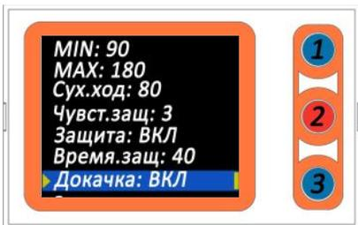
Для включения докачки, необходимо зайти в меню настройки нажав на **кнопку 2** и выбрать пункт вида “Докачка:” в нижней части экрана. После чего при помощи **кнопки 1** выбирается состояние подкачки ВКЛ. Далее настройку необходимо сохранить, задержав **кнопку 2** до характерного звука. Отключение производится аналогично с использованием **кнопки 3** для выбора состояния ВЫКЛ. **Функция подкачки успешно активирована/отключена.**
