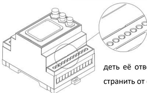
Выходы устройства находятся под пластиковой крышкой, изображенной на рисунке, для её снятия необходимо поддеть её отверткой и небольшим усилием отстранить от основного корпуса.
